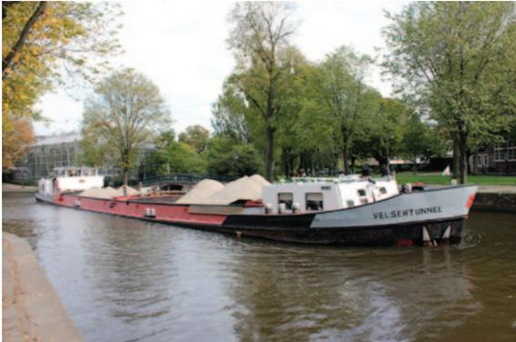
Imagem 23: Exemplo de Barco Urbano de Carga para transporte de material de construção
